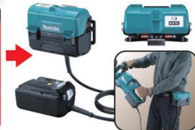
Адаптер BCV01 (195510-1) Позволяет соединить два 18В Li-ion аккумулятора в единый блок 36В и подключить его через провод к инструменту. Не рекомендуется использовать с BBC231U, BBC300L, BC231UD, BC300LD, BUR360, UR360D, BUX360, UX360D
